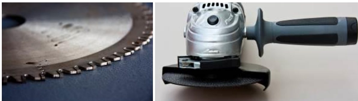
Figur 2: Sag utvikler mye lavere temperaturer ved kutting enn vinkelsliper. Vinkelsliperen kaster glødende gnister langt av sted. Det gjør ikke en sag.
